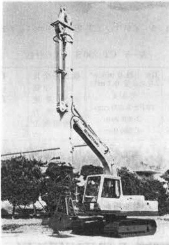
写真-7 住友 S 265 E 深礎掘削機パイプクラム
