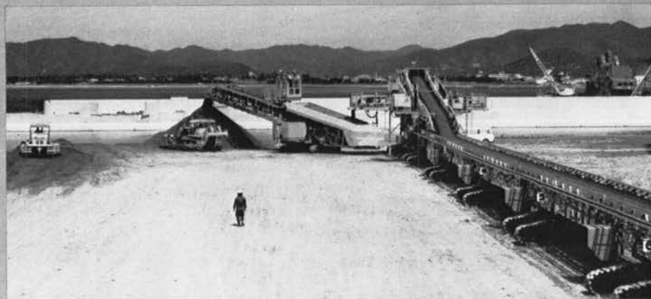
◆可動式ベルコン群：日本コンベヤ 〔クローラの移動〕
