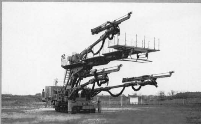
ロボットジャンボ：古河鉱業 〔ドリルさく孔位置，深さ〕⇨
