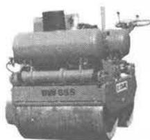
BW65S 重量 650kg 起振力 2.4t 転圧巾 650mm
