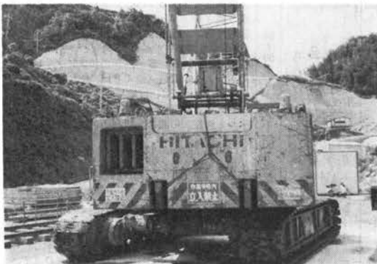
写真-1 旋回警報装置として回転灯を取付けた例
