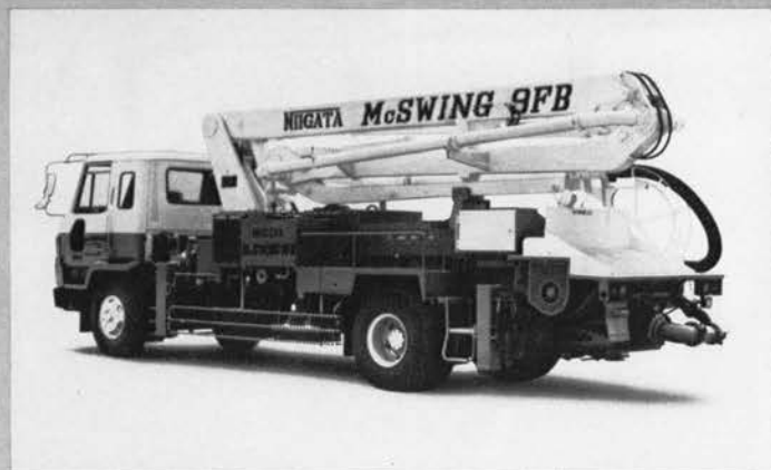
◇コンクリートポンプ車：新潟鉄工所 〔音声合成指示、吐出量〕
