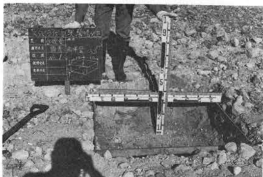
写真-5 含れき量調査
