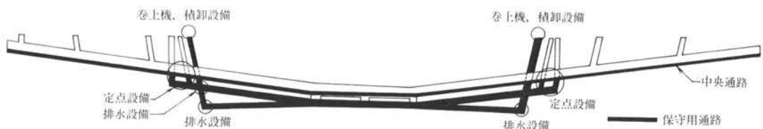
図-6 保守用通路
