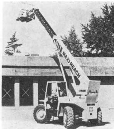
写真-5 テレスコプーム式ラフテレンフォークリフト
