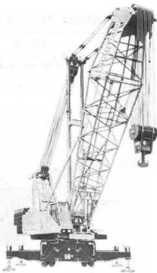
写真-7 住友 HC 268-RH 機械式トラッククレーン
