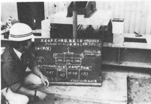
写真-1 PC板の曲げ試験
