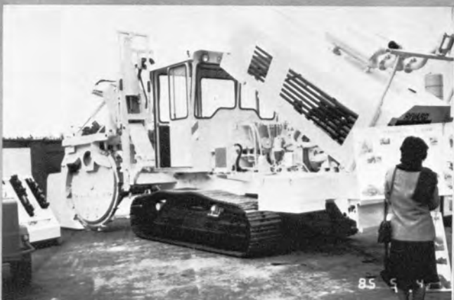
ケーブル敷設機 (RIVARD) ⇨
