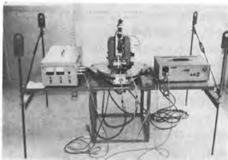
写真-29 シールド自動測量装置
