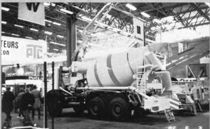
⇨コンクリートポンプを組合せた ミキサ車
