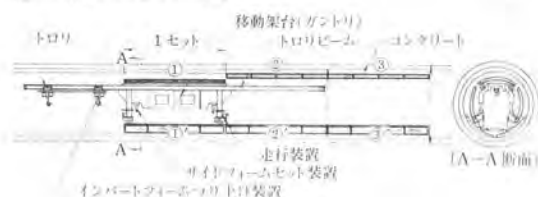
(2) インバートフォーム解体
