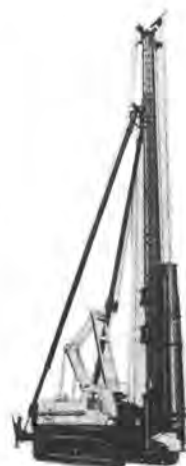
写真-10 KOBELCO-P&H 130 P バイルドライバ
