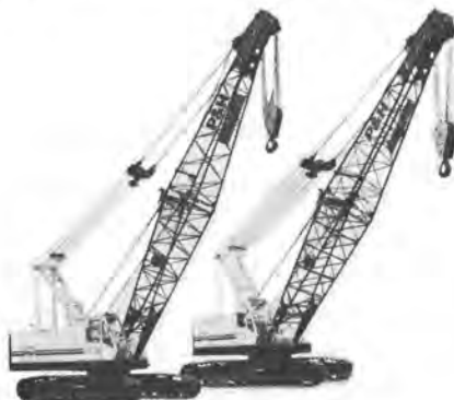
写真-7 神戸 7055, 7065 クローラクレーン
