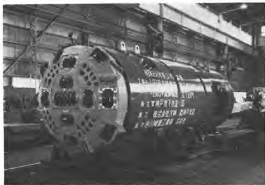
写真—18 全断面掘削流体輸送式 TBM
