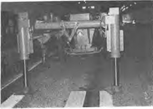
写真-5 コンクリート版の段差修正機
