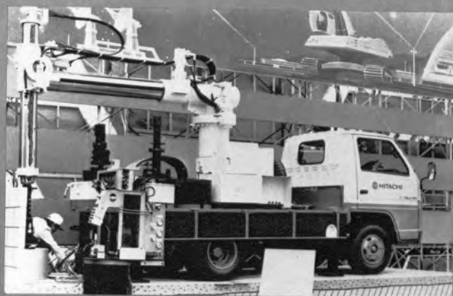
ガス工専用掘削作業車 (日立建機) 拵
