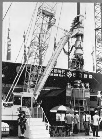
拵 拵底抗施工用油圧アースドリル KH 125 (日立建機)
