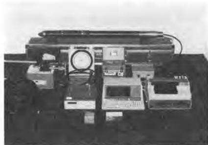
写真—47 孔内載荷試験装置 P-100 計測システム
