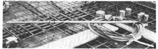
写真-38 細径強力型モータ内蔵バイブレータ (槍型)
