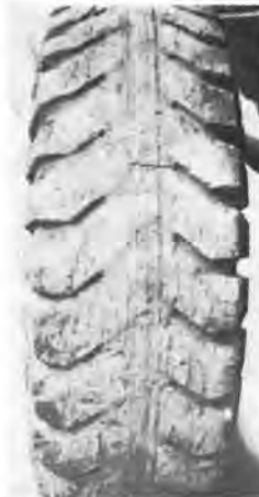
写真-4 トレッドが異常摩耗したタイヤ
