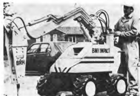
写真-3 全装備重量 750 kg の小型インパクトブレーカ
