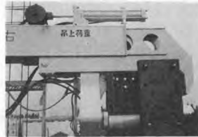
写真-3 柱頭のつかみ
