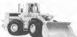
966D ■3.3m 3 (ワースセグメントエンジン付) ■3.5m 3 (ワース付) ■3.7m 3 (キャッチングエンジン付)
