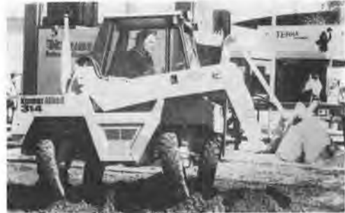
写真-2 横方向、斜め方向に自由に走行できるミニローダ
