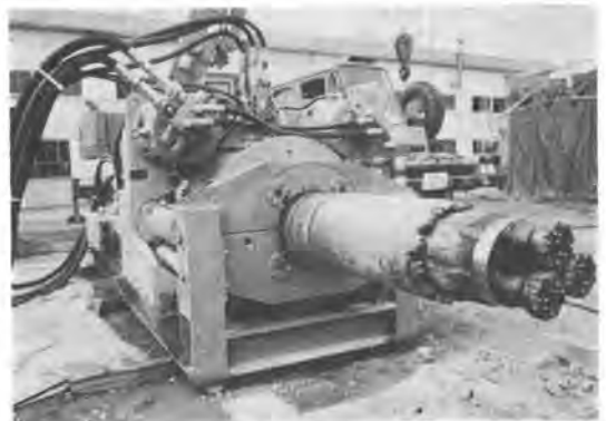
写真-1 推進機本体
