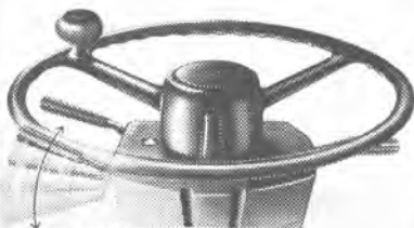
電気式コントロールの変速レバー。
