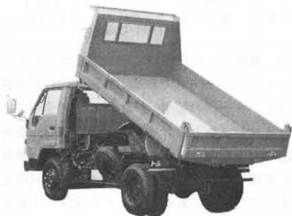
写真-4 トヨタ・トヨエース P-WU 75 D-MDTJ ダンプトラック (3.5t)
