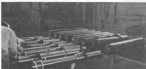
▲シールドジャッキの整備工場
