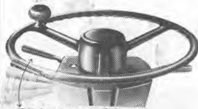
電気式コントロールの、変速レバー。
