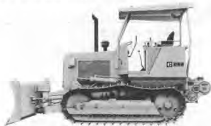
写真1 CAT-D3B ダイレクトドライブブルドーザ (林業仕様)
