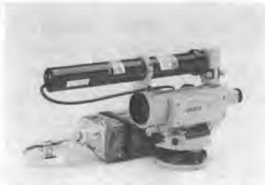
写真-2 トブコンレーザーレベル LTS-3
