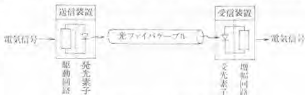
図-2 光通信システム基本構成図
