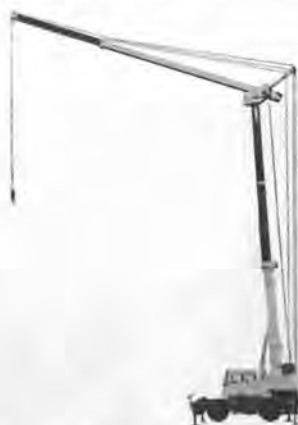
写真-4 神鋼 TK 2500 タワータイプラフテレンクレーン
