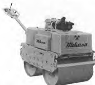
写真-11 三笠 MR-7 D バイブレーションローラ
