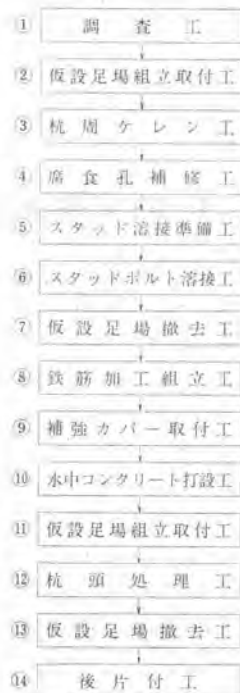
図-7 鋼管杭補強工事施工フロー図
