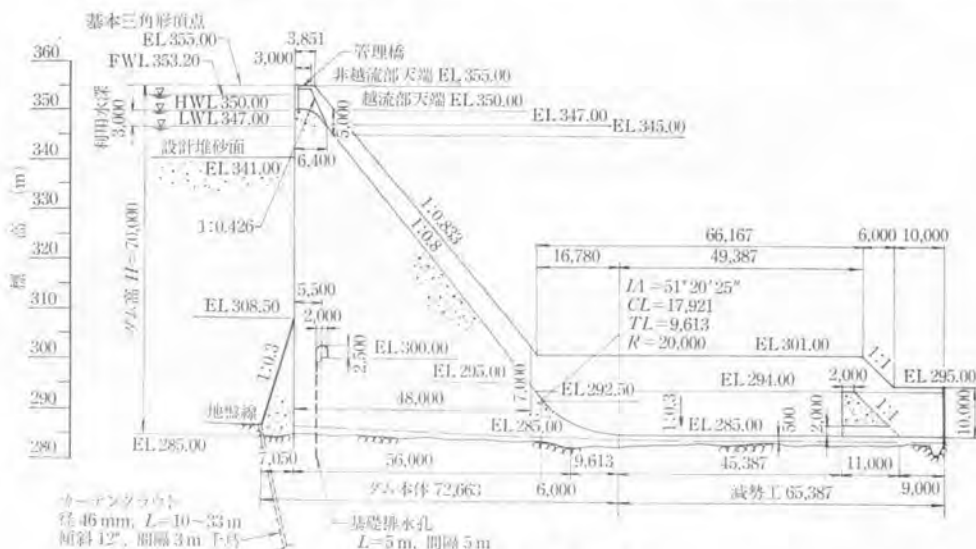
図-4 ダム越流部標準断面図
