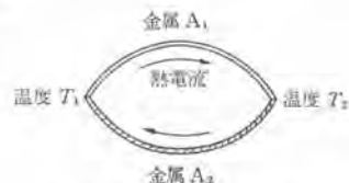
図-5 熱電対による熱起電力
