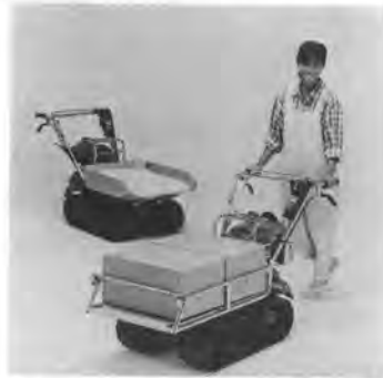
写真-2 ホンダ HP 250 パワーキャリア「力丸」
