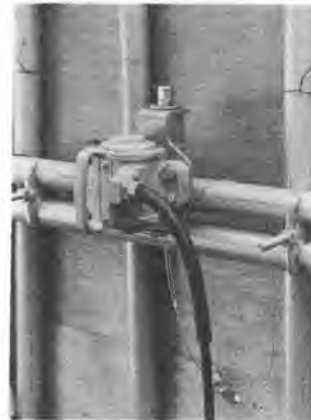
写真-13 三笠 FJ 80 高周波小型自振モータ
