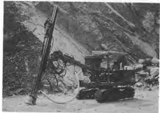
写真-8 山本 HCD-300 油圧クローラドリル
