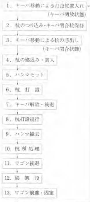
図二 杭打作業フロー
