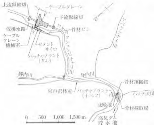
図-6 仮設備全体配置図
