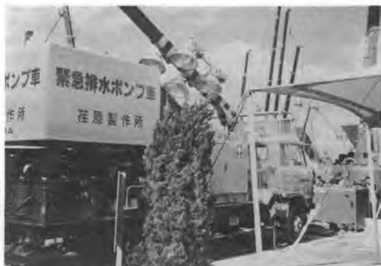
▲ 緊急排水ポンプ車
