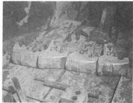
写真-3 ツールビット摩耗状況
