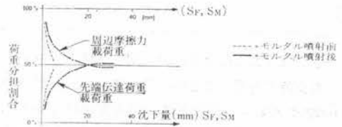
図-5 圧力スタンプン工法モルタル噴射による試験杭の荷重試験結果 (杭 No. 3)
