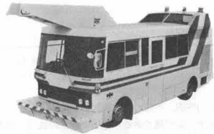
写真-10 小松 ZR 40 L 路面性状自動計測車
