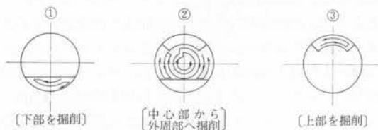
図-8 シールド掘削パターン
