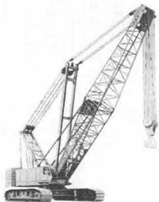
写真-6 神鋼 7250 クローラクレーン
