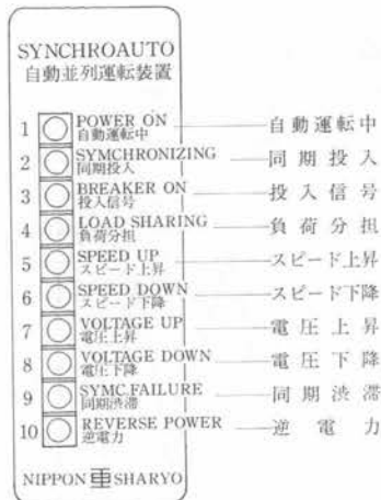
図-6 シンクロートモニタパネル面
