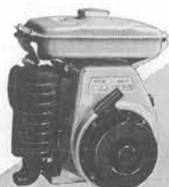
空冷ガソリンエンジン 2.2馬力～12.5馬力
