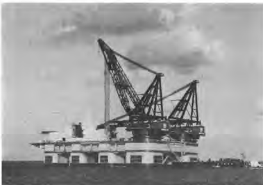
写真-6 三井造船 DB 102/M-5000 全旋回クレーン
