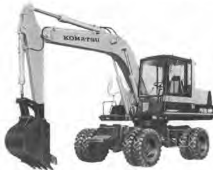
写真-2 小松 PW 100-3 ホイール式パワーショベル
