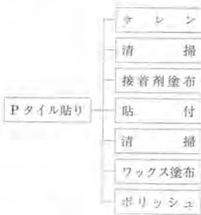
図-1 Pタイル貼工事の構成作業
