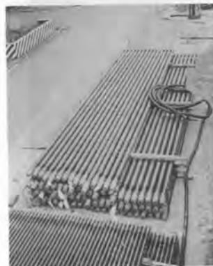
写真-3 掘削用パイプ（中央：5" ウォッシュオーバーパイプ、手前：2-7/8" パイロットパイプ）
