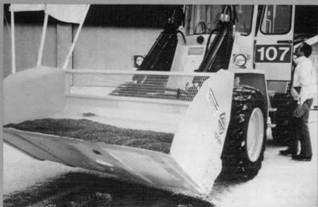
⊕トラクタに取付けた簡易砂散布機 Epoke LM 20 型
