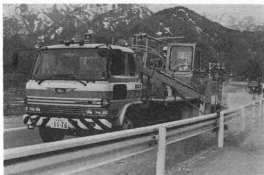
写真-4 ガードレール清掃併用型トンネル清掃車
