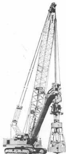
写真—10 日立 KH 125-3 拡底杭施工用 油圧式アースドリル
