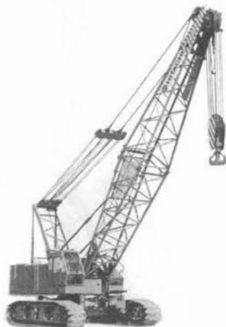
写真-6 日立 KH300-3 油圧式クローラクレーン
