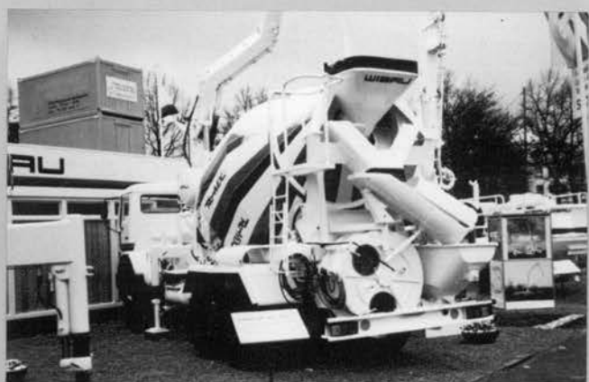
◇コンクリートポンプを組合せたミキサ車 (WIBAU)
