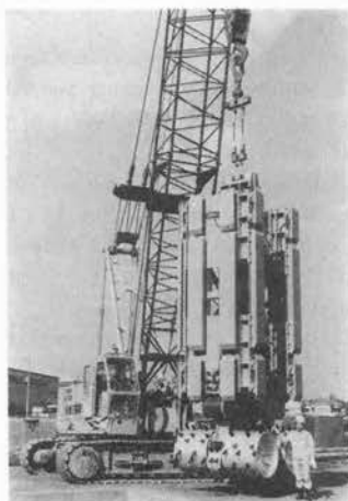
写真—11 利根 EM-240 超厚壁大深度掘削機 エレクトロミル
