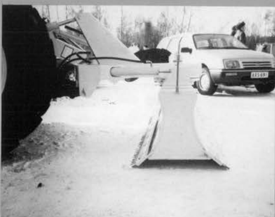
⊕ホイールローダの後方に取付けられた 圧雪処理ブレード
