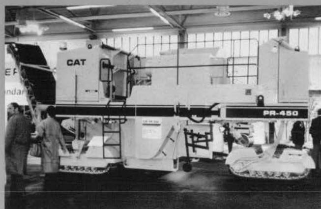
◇路面切削機 (CATERPILLAR PR-450)
