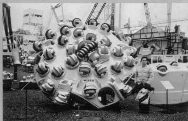
大口径トンネルボーリングマシンの ◆カッタヘッド (WIRTH)
