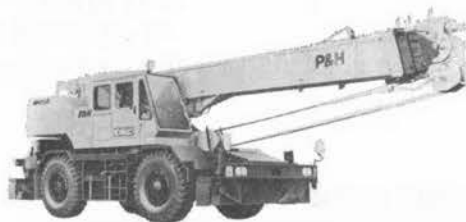
写真-7 神鋼 RK 250 ラフテレーンクレーン
