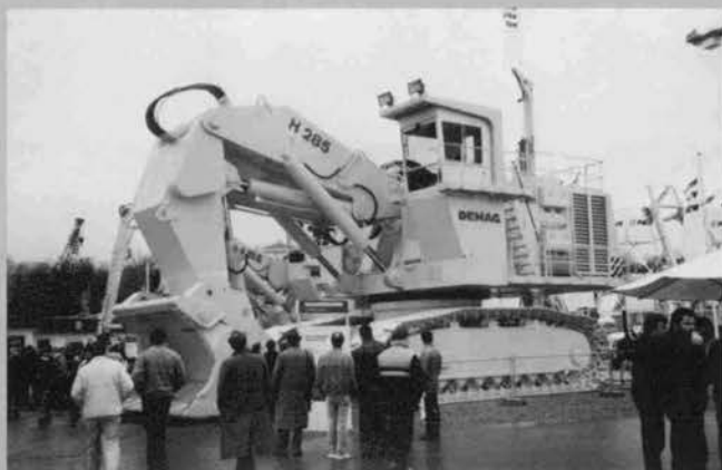
◆油圧ショベル (DEMAG H285) 295t, 1,822HP
