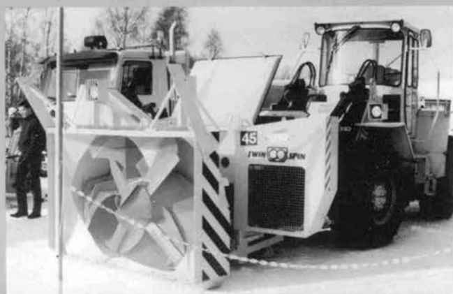
ユニット型ロータリ除雪車 Veraasen (ノルウェー) Twin Spin UPV 135-240S型 (左側のプロワが前に突出している)
