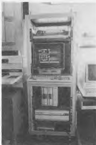
写真-11 シールド自動位置計測装置(地上表示部)
