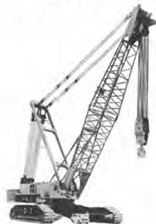
写真-1 850 t ぶりクローラクレーン
