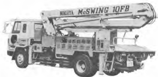
写真-11 新潟 NCP 10 FB コンクリートポンプ
