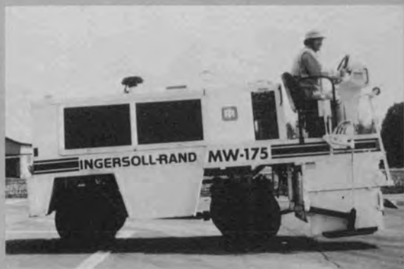
◆路面切削機 (MW-175型)
