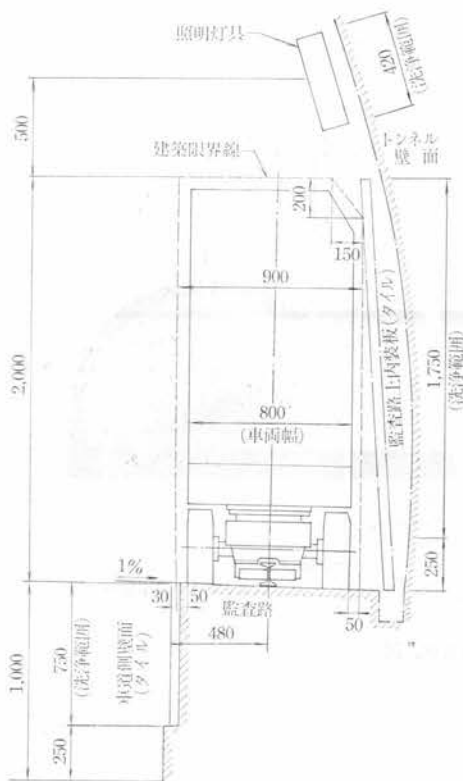
図-3 建築限界および洗浄対象範囲
