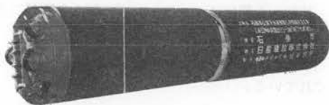
写真-1 TBM 本体
