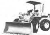
WA100 ホールローダ ● バケット容量…1.2m 3 ● 運転整備重量…6555kg
