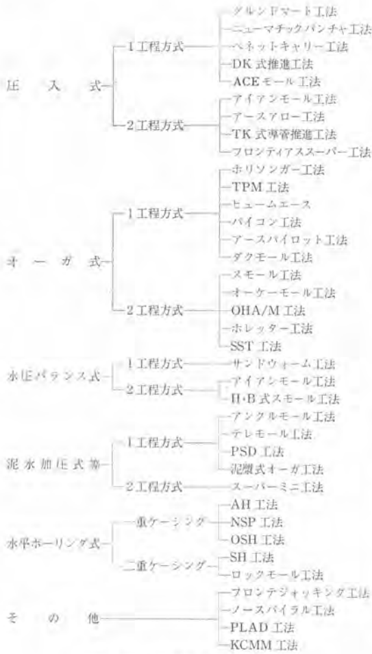
図-10 小口径推進工法の分類
