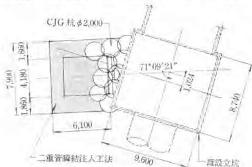
図-8 既設立坑到達部防護工
