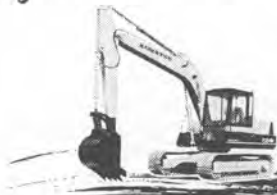
掘削Pワー族群。スピーディな積み込み。 PC-120Pワーショベル ● バケット容量…0.45m 3 ● 運転整備重量…11600kg
