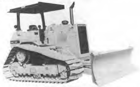
写真2 キャタピラー D4H LGP 湿地ブルドーザ
