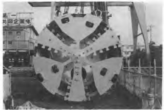
写真2 シールド機面板
