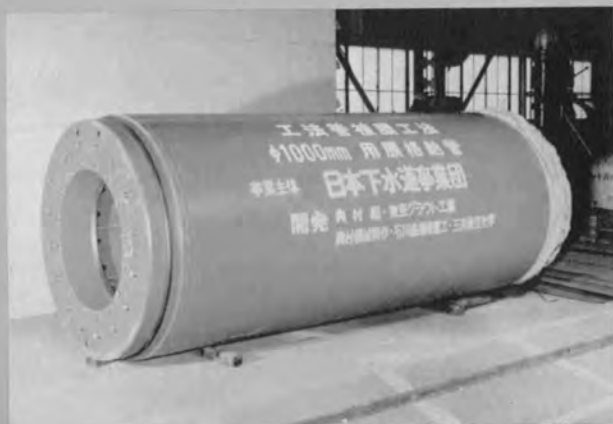
⇨ 不透水膜の格納管（推進工法）
