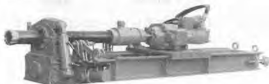
写真-6 鉤研試錐 RPD-60 S-D 3 ライナプレート内せん孔専用機
