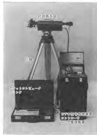
写真-1 トンネル断面計測装置
