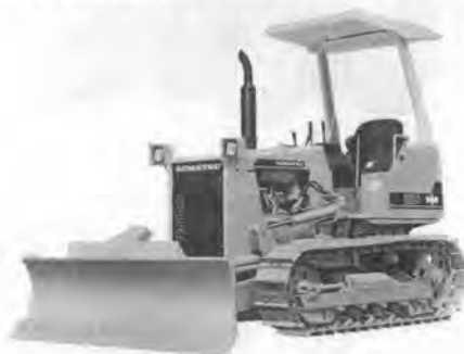
写真-7 小松 D 21 Q-6 湿地ドーザショベル
