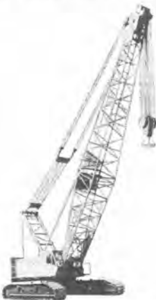
写真-7 KOBELCO-P&H 7150 クローラクレーン
