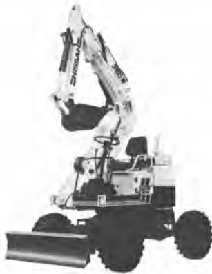
写真-3 日産機材 S&amp;B15W バックホウ
