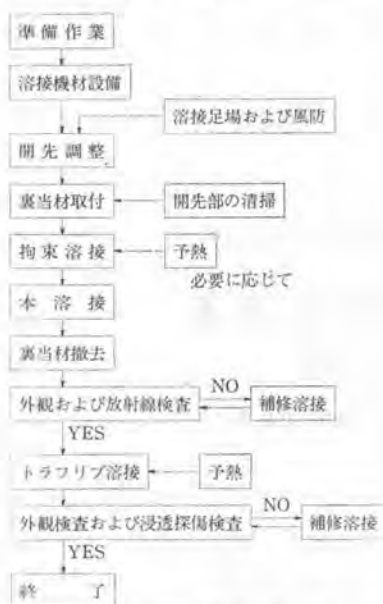
図-9 鋼床版溶接フローチャート
