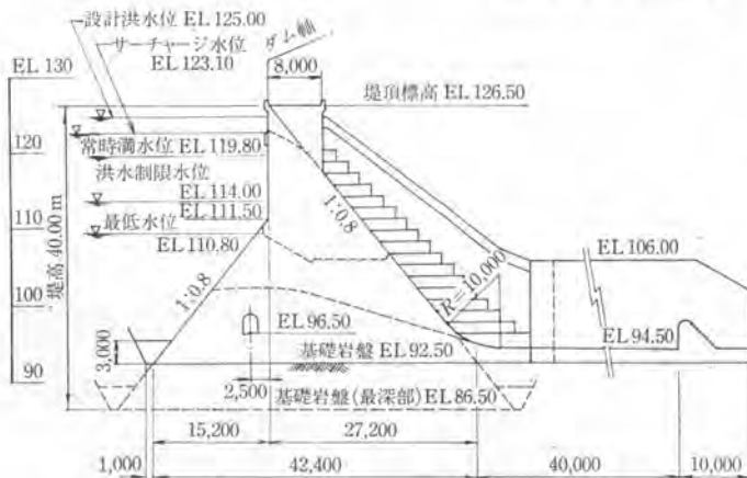
図-3 越流部標準断面図
