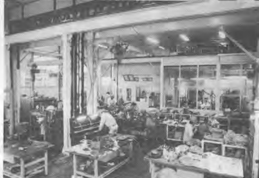
▲油圧ポンプ、モータ、バルブ整備工場
