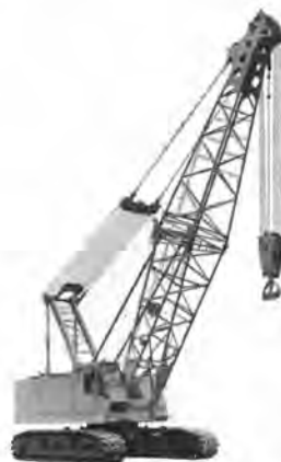
写真-8 KOBELCO-P & H 7080 クローラークレーン
