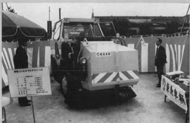
⇨道路清掃機械 (全長4.05, 全幅1.55m)
