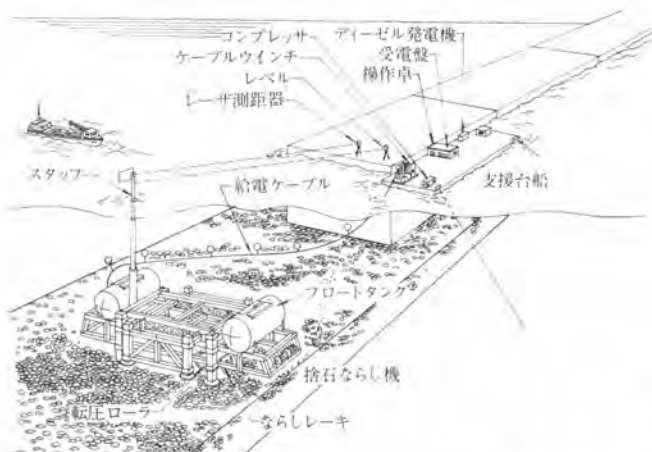
図-4 捨石ならしロボットシステム図
