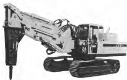
写真-12 三菱 MTB 300 トンネルブレーカ
