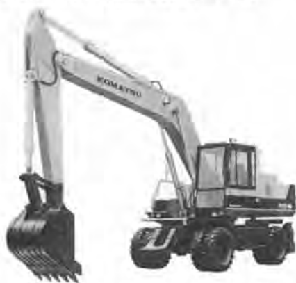
写真-1 小松 PW 200-1 パワーショベル
