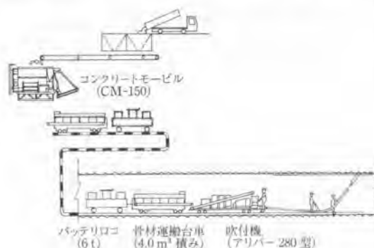
図-11 吹付け施工見取図
