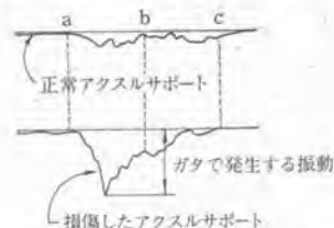
図-2 アクスルサポートの振動波形
