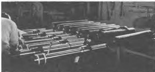
▲シールドジャッキの整備工場
