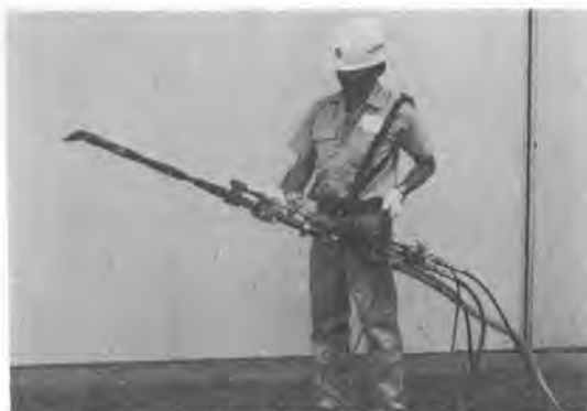
写真-3 ノズル部装置
