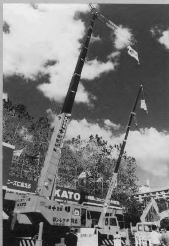
国内最大つり重量 45t の ラフテレーンクレーン
