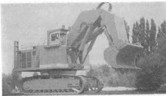
写真-4 超大型油圧ショベル H485
