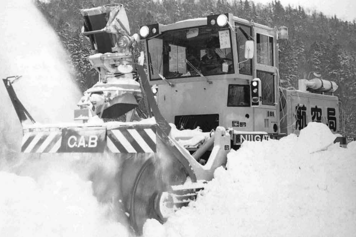
NR821 ロータリ除雪車 株式会社 新潟鉄工所
