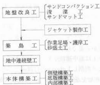
図-4 川崎人工島施工フロー
