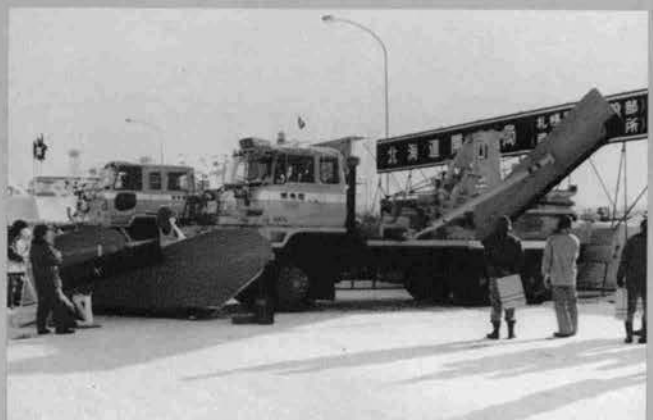
◆サイドウイング切換装置付 10 t 級除雪トラック (北海道開発局)
