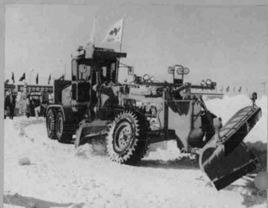
◆320 PS 級除雪グレーダ [高速除雪車] (小松製作所)
