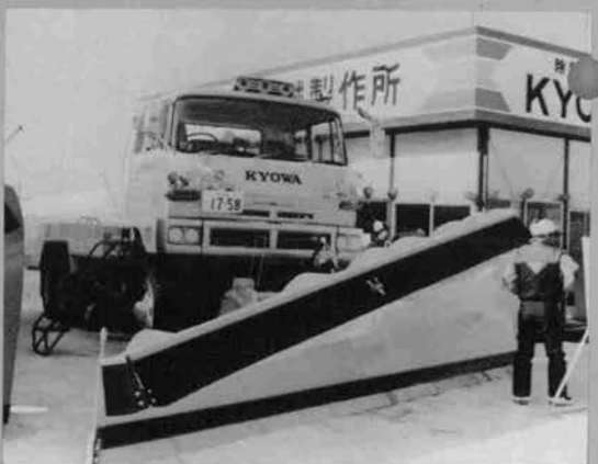
◆4.5 m ワンウェイブロー付除雪トラック (協和機械製作所)
