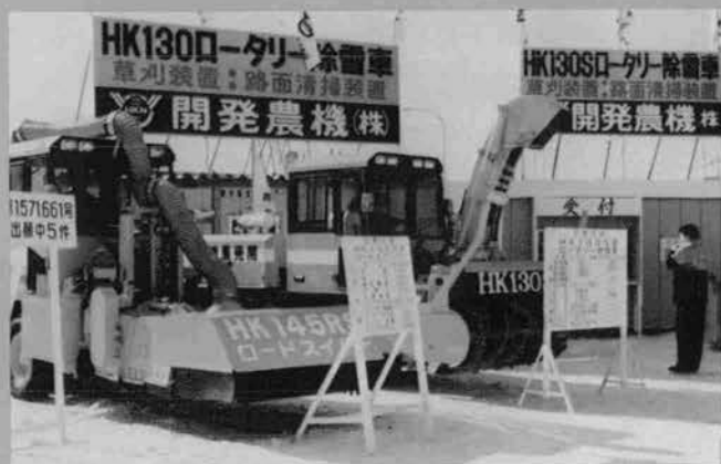
◇80PS級ロータリー除雪車 (開発農機)
