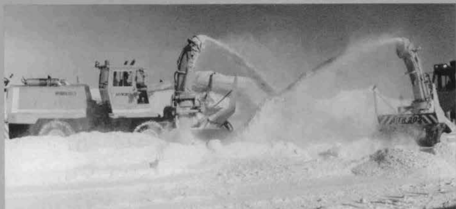
◆350 PS, 200 PS ロータリ除雪車 (日本除雪機)
