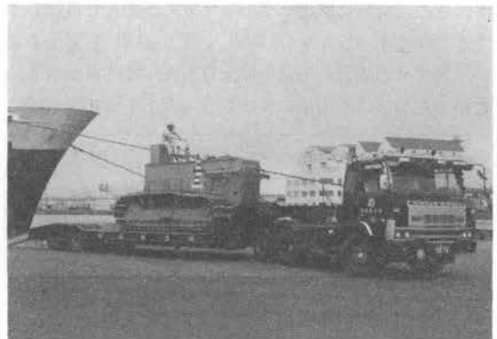
写真-6 自走用の特設運転装置 (トレーラへの積込)
