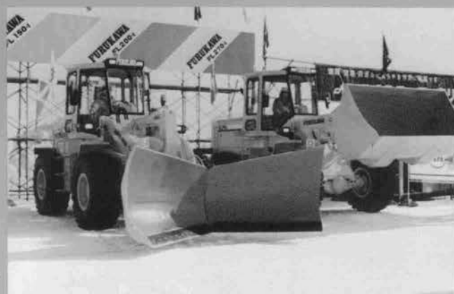
◆10 t 級 マルチブラウ付 除雪ドーザ (古河鋳業)
