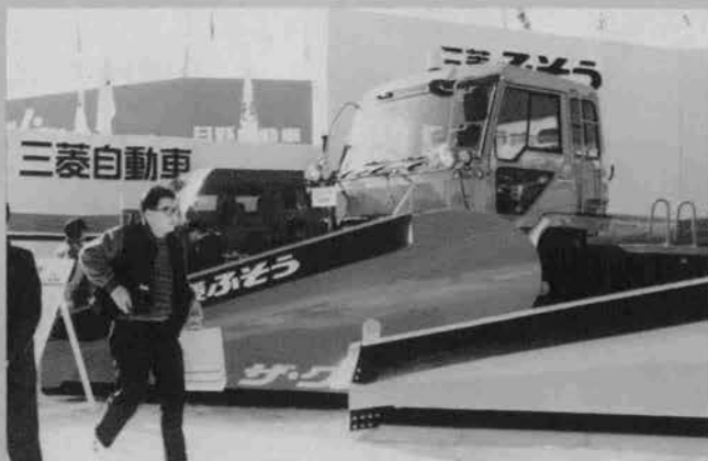
10t級除雪トラック〔6×6〕 (三菱自動車工業)
