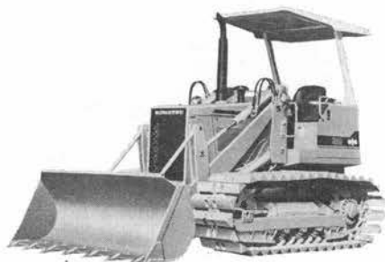
写真-5 小松 D31Q-18 湿地ドーザーショベル
