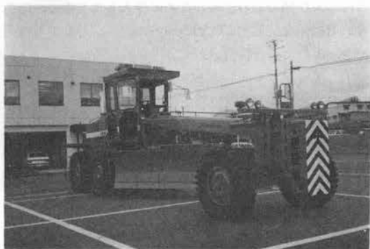
写真-3 高速除雪専用グレーダ
