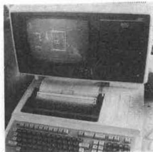
ディスプレイ装置は次のように表示され、所定の位置に入ると「コピー」キーによりハードコピーできるようになっている。
