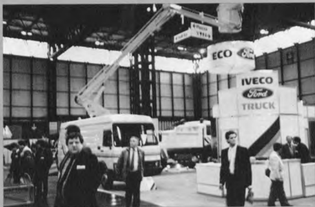
⇨ IVECO 社のワゴン車を改良した 高所作業車 — バーミンガム ICE
