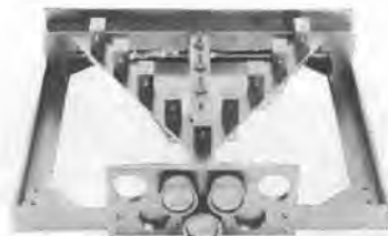
写真-21 トンネル測量装置ターゲット
