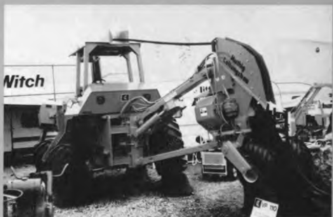
◆電線埋設機—ハノーバーメッセ◆
