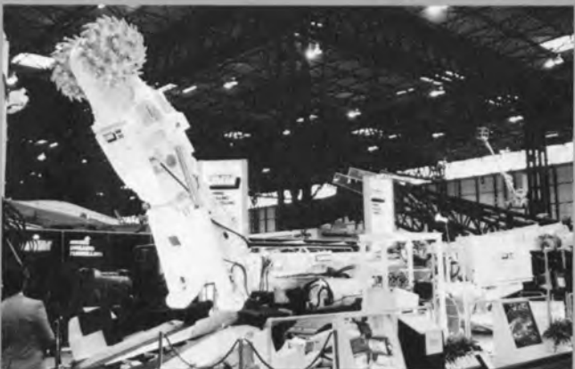
UMM 社のトンネル掘削機 —バーミンガム ICE
