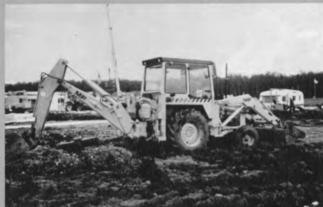
⇨ MASSEY FERGUSON 社のバックホウローダ (農業トラックから発展したものか。アーティキ ュレートなし) — バーミンガム ICE
