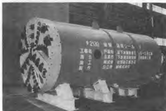
写真—19 3折式岩盤シールド機
