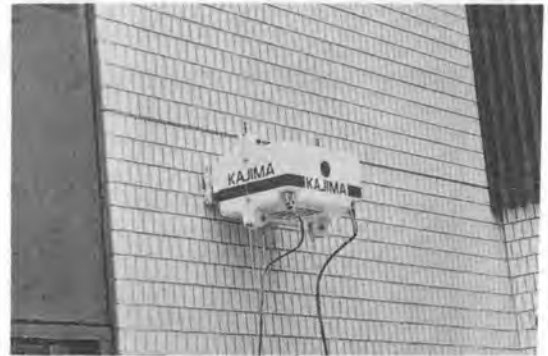
写真—36 タイル壁面剝離検知ロボット
