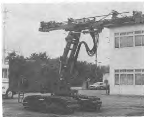
写真-2 自走クローラ式ボルト打設機
