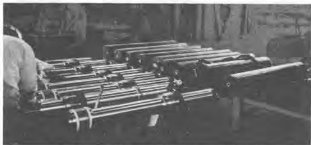
▲シールドジャッキの整備工場
