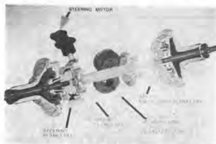
写真-4 キャタピラー D 8 N のディファレンシャルステアリング
