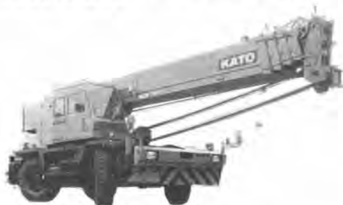
写真-6 加藤 KR-30 H-III ラフター
