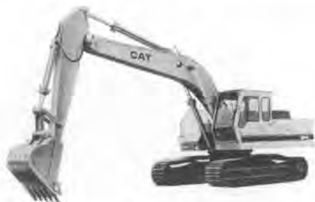
写真-3 CAT・E180 油圧ショベル
