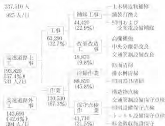
図-6 維持修繕工事年間出勤人員
