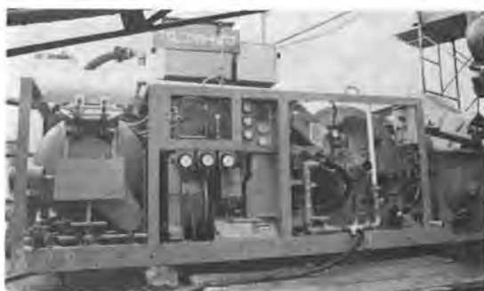
写真-3 コンクリートおよび急結剤圧送装置 (ショットクリート PQ 08 改良型)
