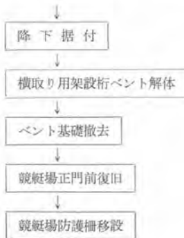
図-4 地組横取工法（清掃局中部中継所（P 1 -248～J 12 間）架設（II測線）要領）
