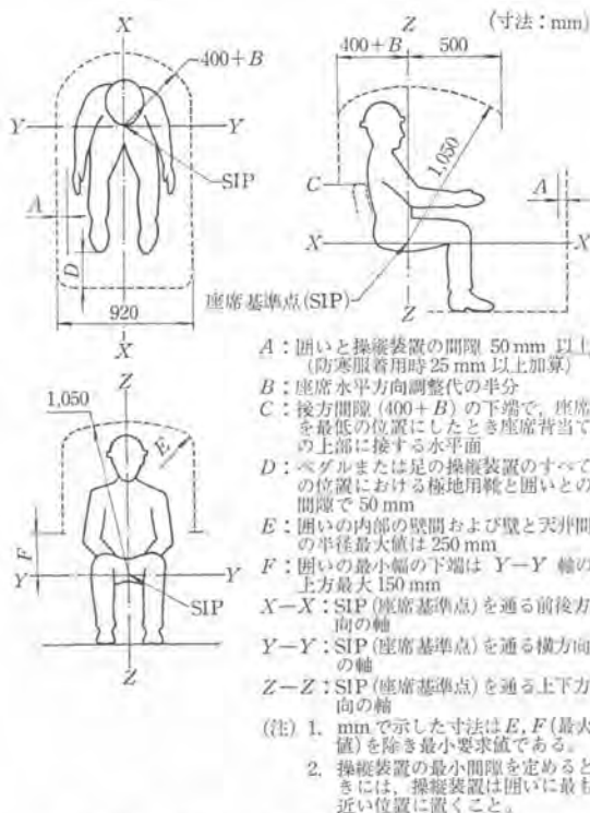
図-5 運転員に必要な最小空間 (作業衣着用時着席時の運転員)
