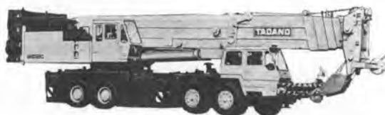
写真-5 多田野 TG-1600M 超大型油圧式トラッククレーン
