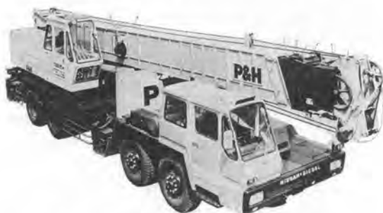
写真-4 神鋼 T450V 油圧式トラッククレーン
