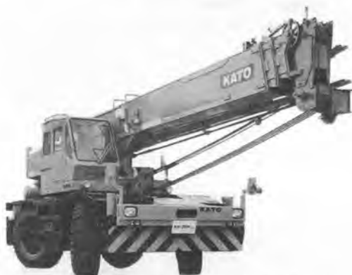
写真-6 加藤 KR-45 HIII ラフテレーンクレーン
