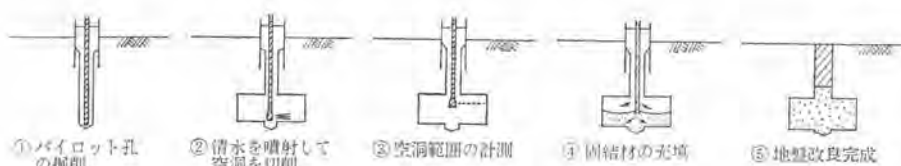
図-3 SSS-MAN 工法の施工手順
