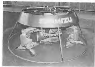
写真-5 エンジン駆動式コンクリート床仕上げロボット
