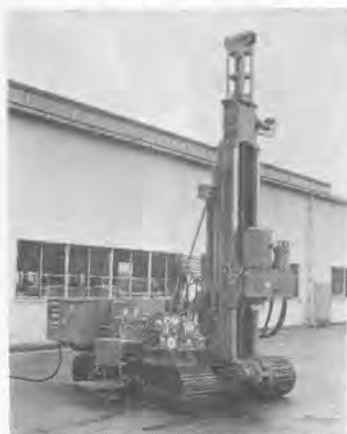
YBM-SS-60地盤改良機
