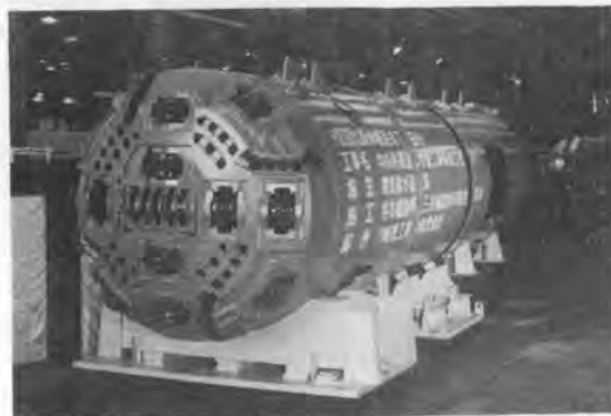
写真-8 φ2 m トンネル掘削機 (流体輸送式)
