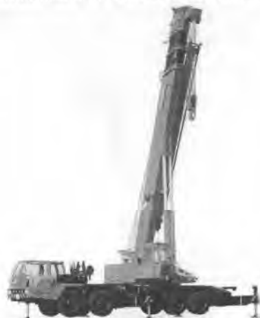
写真-2 多田野 TG-450 M-III トラッククレーン
