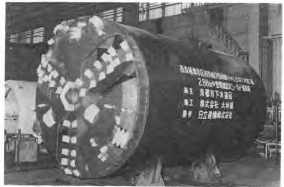
写真-4 \phi 2.88\text{ m} 密閉加泥式シールド (れき砕型)
