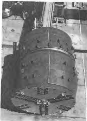
写真-3 \phi 6.14\text{ m} 泥水式シールド (中折装置付)
