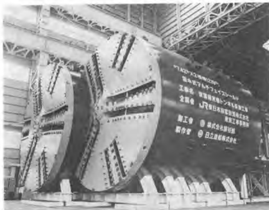
写真-7 φ7.42 × 2 m 泥水式マルチフェイスシールド
