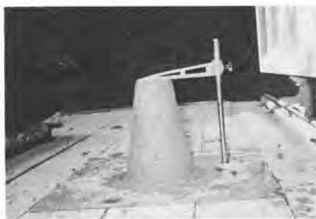
写真-2 排出土のスランプ試験
