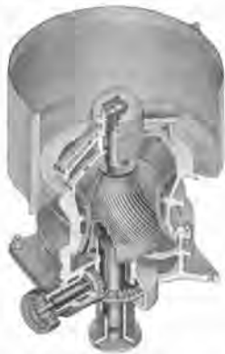
図-4 ウルトラコース（川崎重工業）の構造とマンツルの波形
