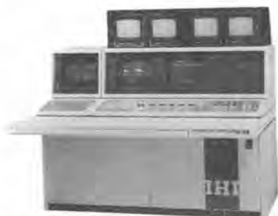
写真-2 コンピュータ化した最新の操作盤
