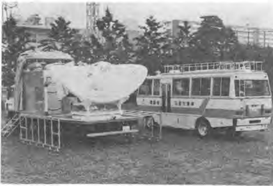
写真-7 災害対策車（移動型地球局，指揮・無線一体型）
