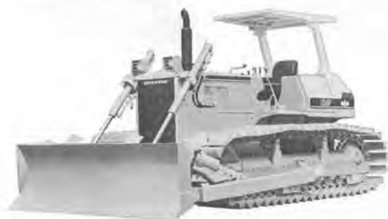
写真-1 小松 D50 P -18 湿地ブルドーザ
