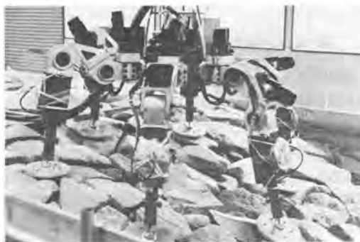
写真一 捨石斜面歩行実験中のアクアロボ （水中調査ロボット試作1号機）
