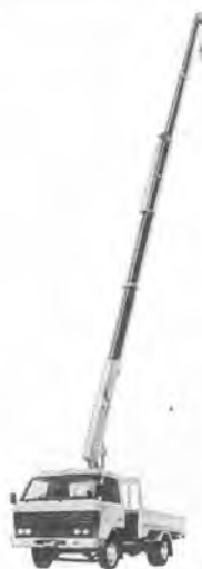
写真-7 多田野 Z 255 カーゴクレーン
