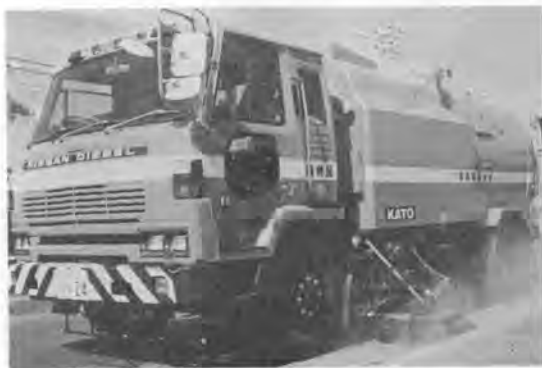
写真-2 真空無水式路面清掃車
