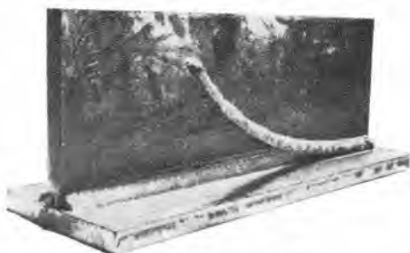
写真-7 スラグの剝離性が良い
