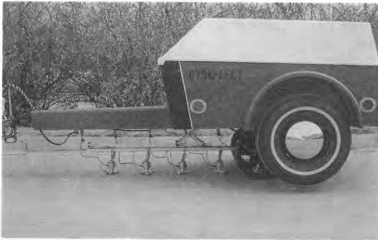
写真-1 たわみ試験機の使用現場
