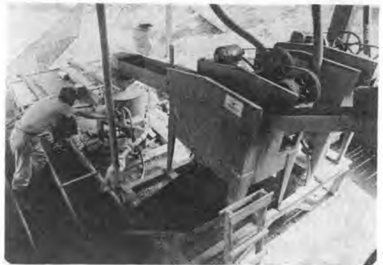
写真-4 YD 鉱山選鉱場(前・ジグ選別機, 中央・キーネルソン選別機)
