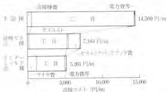
図-2 溶接コスト比較（立向上進裏波溶接、板厚 12 mm）
