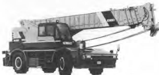
写真-7 神鋼 RK 450 ラフテレーンクレーン
