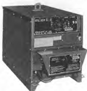
写真-4 直流溶接機
