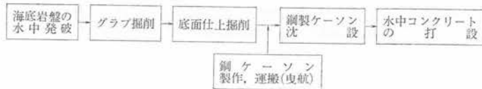
図-2 設置ケーソン工法の施工フロー
