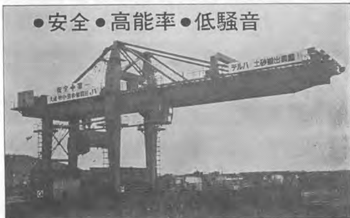
YBM-110型 バケツ8M 3 能力150M 3 /H (地下25Mより)
