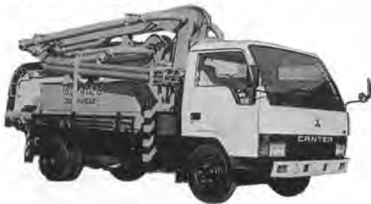
写真—9 丸伸 MKW-35 CB コンクリートポンプ車
