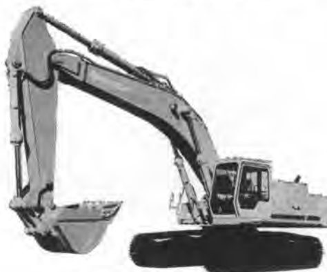
写真-2 日立 EX 400 油圧ショベル
