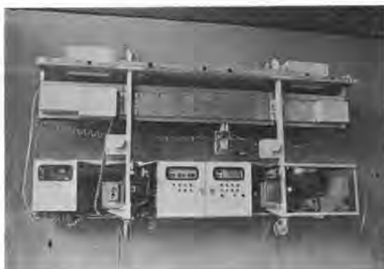
写真-1 正面から見た確認実験中の外壁自動吹付け装置外観
