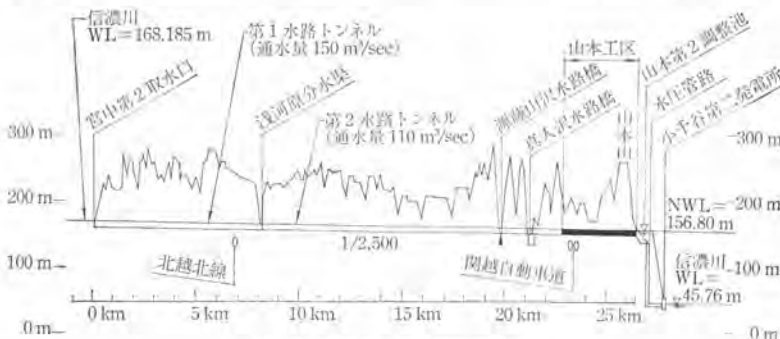
図-1 水路トンネル縦断面図
