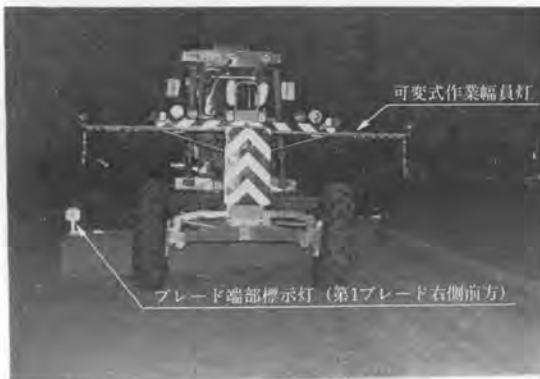
写真-4 作業幅員灯
