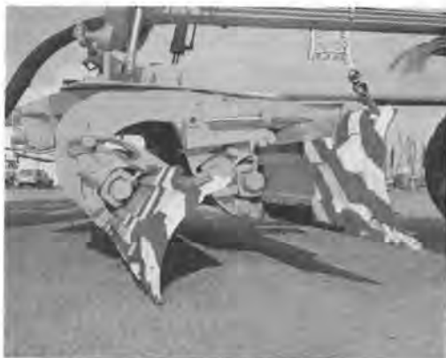
写真-3 ブレード取付状況
