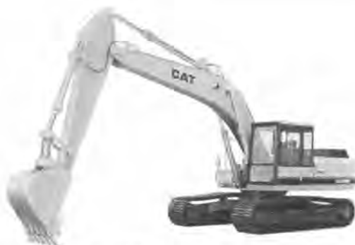
写真-2 CAT EL 200 B 油圧ショベル
