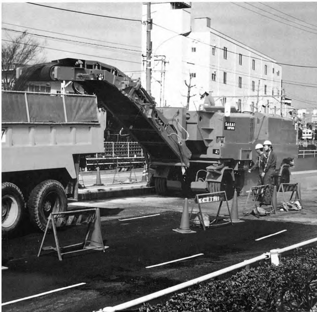
コールドプレーナー積込装置付 ERF 600 型 — 酒井重工業株式会社 —
