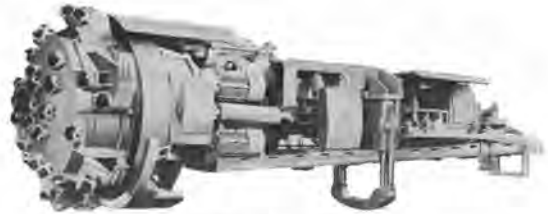
写真-6 全断面トンネル掘削機 (TBM)
