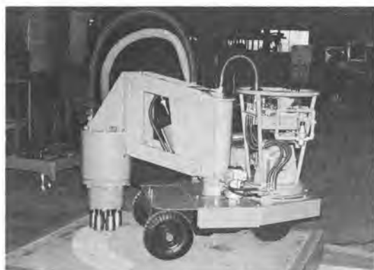
写真-8 栗田 M-3 コンクリートはつり機
