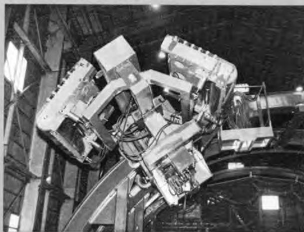
◆FSD吹付コンクリート形成装置（佐賀工業） 孔壁——ベルト型枠の間に急結コンクリートを吹込んで一次覆工を行う、吹付け、型枠移動などを自動化
