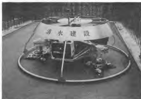
写真-4 床仕上げロボット（清水建設）
