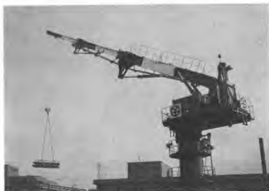
写真-4 コンディスクレーン（クレーン仕様）
