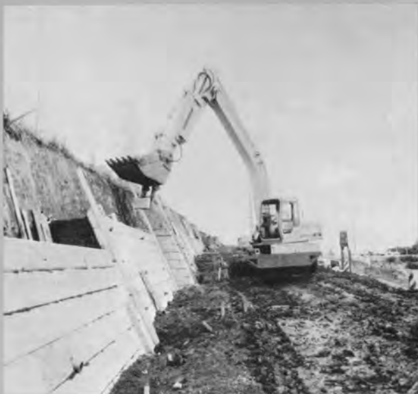
⑥土地造成万能ロボット (東急建設) 土地造成工事における掘削、ブロック積、ヒューム管据付などの作業をアタッチメント交換なしで行える、リモコン可能、バケット水平保持等を自動化
