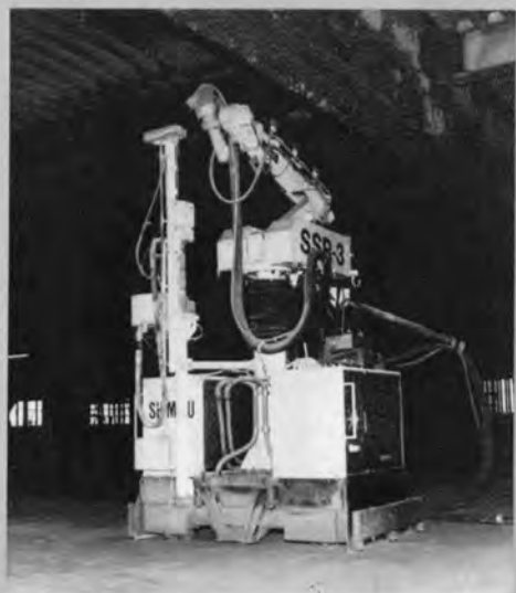
④耐火被覆吹付ロボット (清水建設) 梁の位置・形状を入力してやると、指定の位置にロボットが自動的に移動し、指示した場所に所定厚の耐火材を吹付ける
