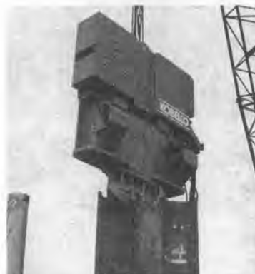
写真-5 ICE コベルコ SHP 15 油圧パイプロハンマ
