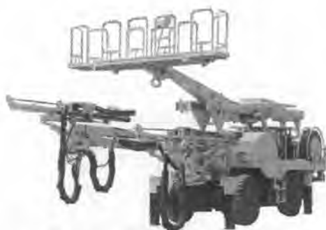
写真-4 4輪駆動、前後独立方式のタイヤード台車付ロボットジャンボ(T社)
