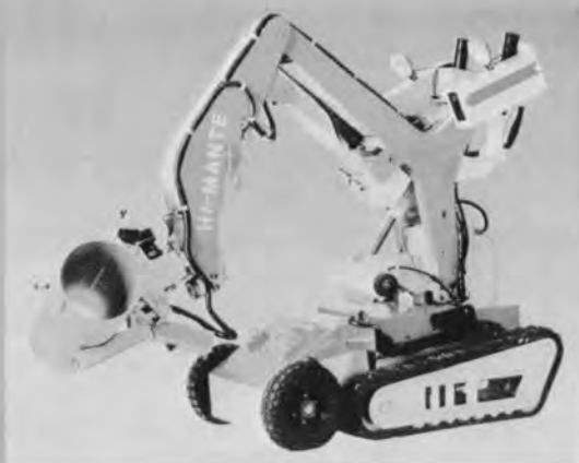
④リモコン移動式マニプレータ (東洋運搬機) 原子力施設の解体撤去作業などに使用、台車上の4台のTVカメラで監視してリモコンする
