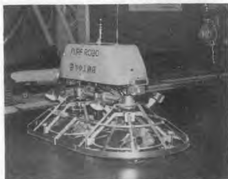
写真-3 床仕上げロボット（竹中工務店）
