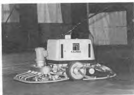
写真-2 床仕上げロボット（鹿島建設）
