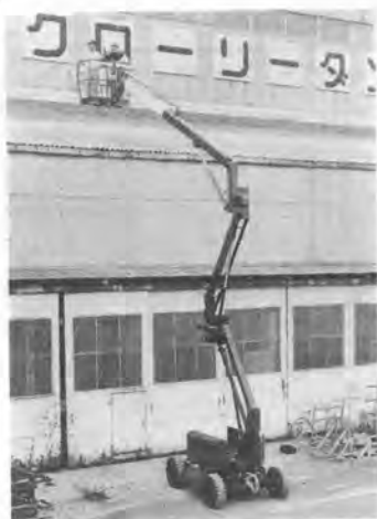
写真-3 東急 BOXER 2 高所作業車
