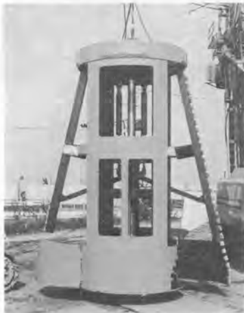
写真-15 拡底径 2.6~4.1 m 用 OMR/B 掘削機
