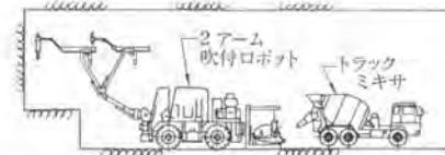
図-2 システム概要図 (SMB 工法) および施工順序図
