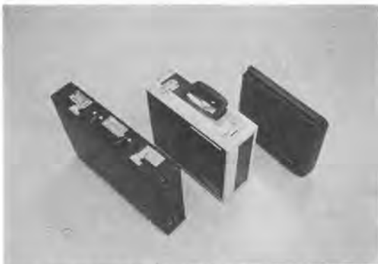
写真-3 位置測量装置 (右・携帯用パソコン, 中・電源装置, 左・データ切換装置)
