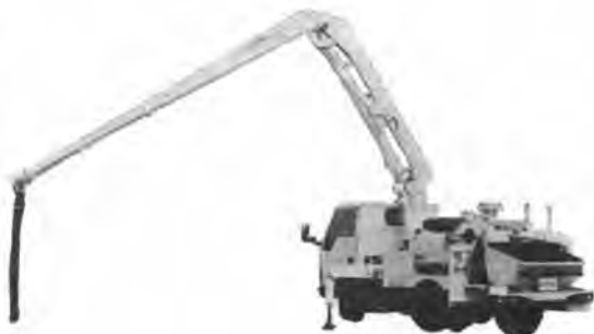
写真-7 極東シテイクリート PH 20-11 ブーム付 コンクリートポンプ車
