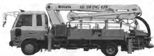
写真-6 新潟 NCP-6 FB コンクリートポンプ
