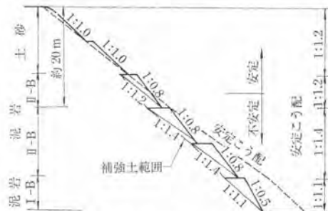
図-5 補強土の範囲例
