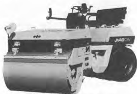
写真-8 小松 JV 40 CW 振動ローラ
