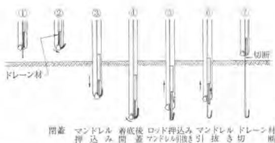
図-1 打設の原理
