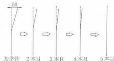
図—6 基準管が計画より5cm変位した場合の推進方法
