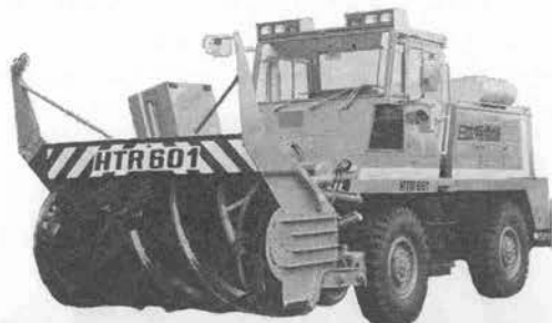
写真-12 日本除雪機 HTR 601 ロータリ除雪車
