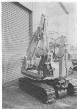
写真-2 レンタルのニッケン小型電動油圧ショベル “宮本武蔵”
