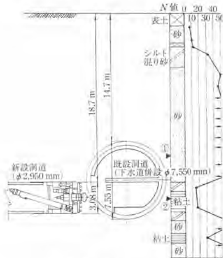
図-3 地中接合部土質断面図
