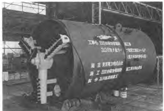
写真-1 スライドフード押出し前
