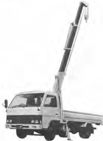
写真-6 タダノ Z204 カーゴクレーン
