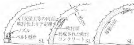
図-5 吹付け方式の施工概要
