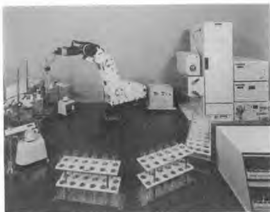
写真-1 ロボットによる安定液の計測
