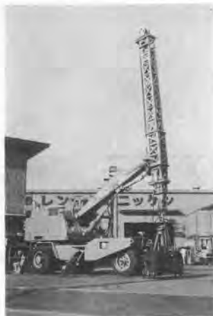
写真-4 レンタルのニッケン NWLB-T 11 ホイール式トラスロングアーム
