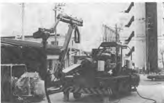
写真-2 吹付ロボット (吹付機・急結剤供給装置・吹付ロボット一体型)
