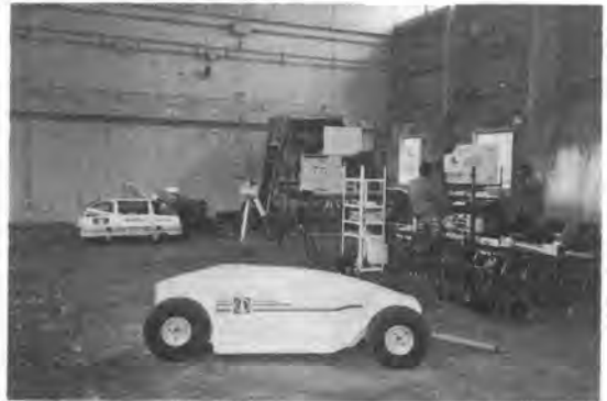
写真-1 電磁波による方式（後方）とインピーダンスヘッドによる方式（前方）
