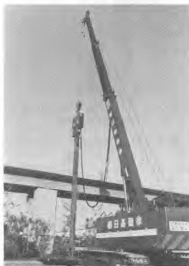
写真-8 石川島 CCH 300 T 全油圧スパンナクレーン
