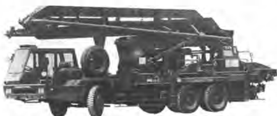
写真-10 石川島 IPF 100 B-7 E 32/4 コンクリートポンプ車
