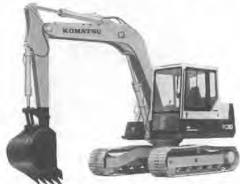
写真-3 小松 PC 90 アバンセ油圧ショベル
