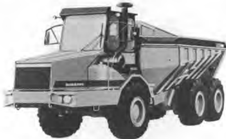
写真-6 小松 HA 250 アーティキュレート式重ダンプトラック
