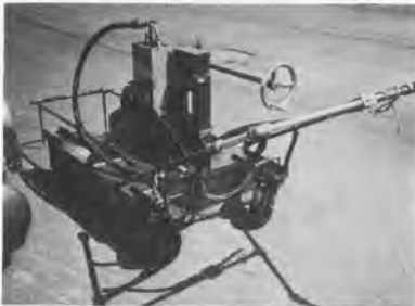
写真-6 高圧水噴射装置 (ロトブラスター)
