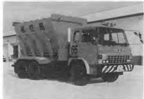
写真-4 薬剤散布車 (10 m 3 )
