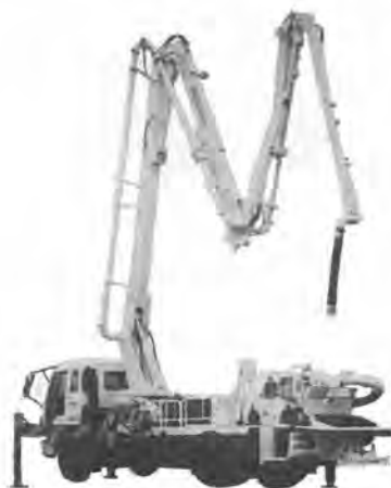
写真-7 極東開発 PH 75-25 コンクリートポンプ車
