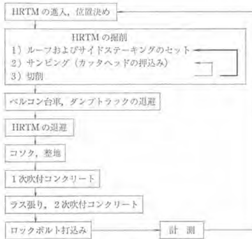
図-2 施工フロー
