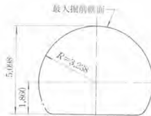
図-7 1回のセッティングで切削できる範囲
