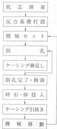
図-6 置換掘削工施工フロー
