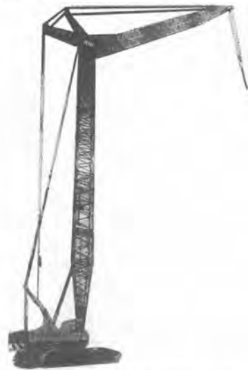
写真-5 石川島 CCH 800-2 全油圧スパンナークレーン
