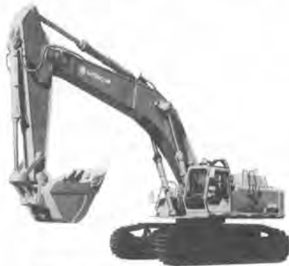
写真-1 日立 EX 700 油圧ショベル
