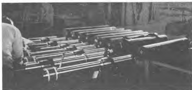
▲シールドジャッキの整備工場
