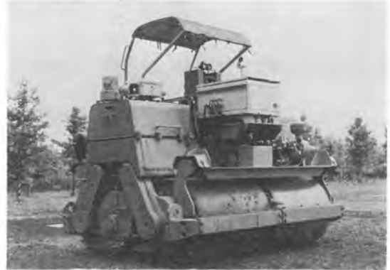
写真-3 振動ローラ (車両側制御装置)
