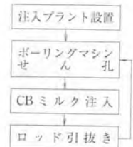
図-10 根固め注入工施工フロー
