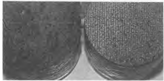
写真—1 凍結融解試験 300 サイクル後
