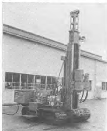
YBM-SS-60地盤改良機
