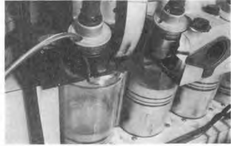
写真-2 グローブプラグを取らずにファイバースコープにてバルブを点検（カットモデル使用）
