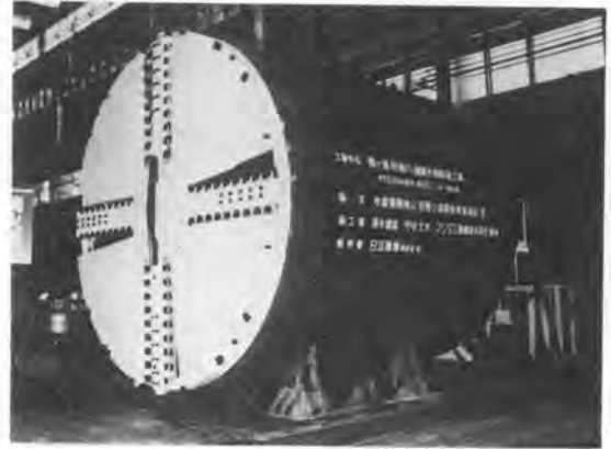
写真-1 φ5,230 泥水シールド掘進機
