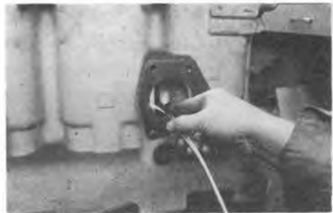
写真-3 オイルクーラを取らずに、ライナ外周のピッチングを点検している
