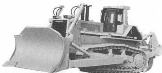
写真-1 小松 D 475 A-2 ブルドーザ
