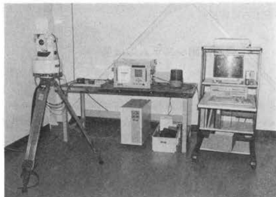
写真-1 地すべり自動観測システム（左から自動光波測距・測角一体儀、気温・気圧センサ、制御装置、無停電電源装置（制御装置の下）、黄色回転灯、出力装置）
