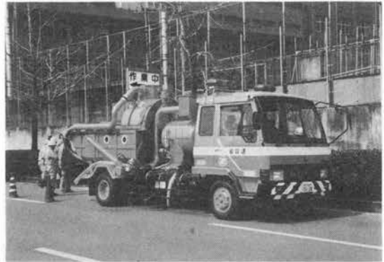
写真-4 側溝清掃車 (真空脱水装置付)
