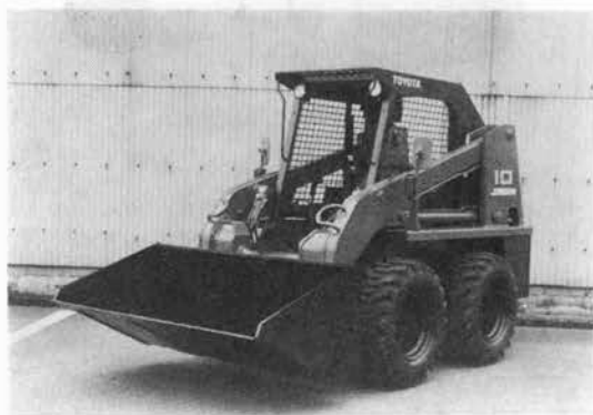
写真-4 トヨタ SDK 10「ジョブサン」スキッドステアローダ
