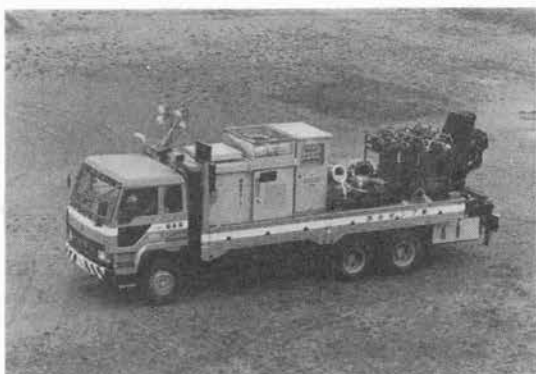
写真-6 排水ポンプ車(45 m 3 /min)
