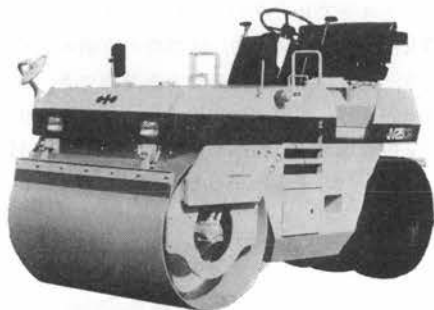
写真-8 北越 BW 123 AC 振動ローラ
