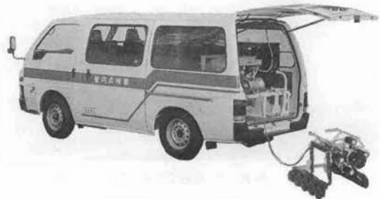
写真-2 管内点検車と点検用装置
