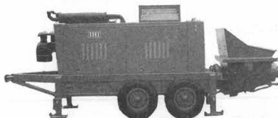
写真-8 石川島 IPG 60 ST-18 N (ハイパーストロック) コンクリートポンプ
