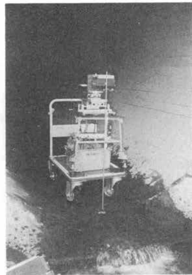
写真-5 鉛直ロッドを使った水中基準点からの位置決め状況
