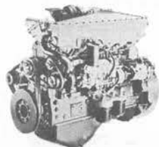
6D22-TC型インタークーラターボ付直噴エンジン
