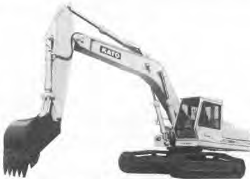
写真-1 加藤 HD-900 V II 油圧ショベル
