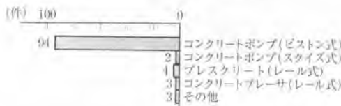
図-11 コンクリート打設機械
