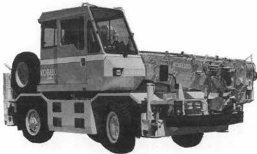
写真-4 神鋼 RK 70 M ミニラフテレーンクレーン
