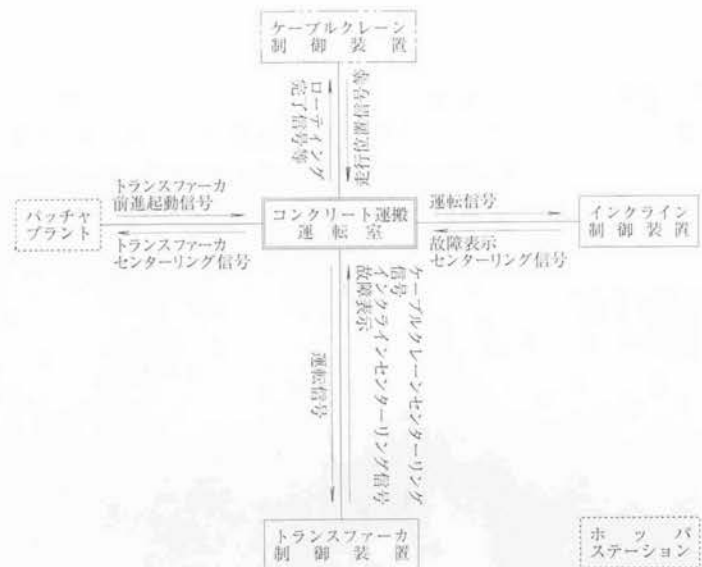
図-8 運転制御装置のシステム構成
