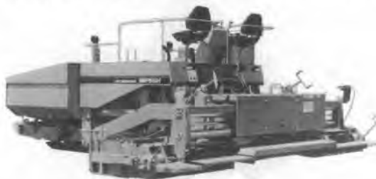
写真-6 三菱 MF 55 H アスファルトフィニッシャー
