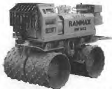
写真-4 サカイ・ラマックス RW 1402 振動トレンチローラ
