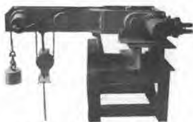
写真—2 オートレッド測深機測深検出部
