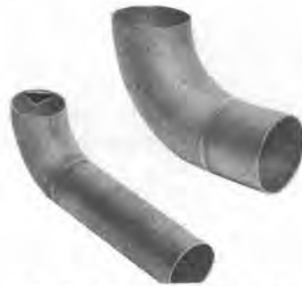
写真-7 ステンレス配管の全姿勢溶接例
