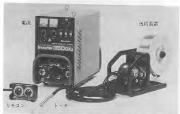
写真-2 日立インバータスーパーオート CX 2 (CO 2 ・マグ溶接機)
