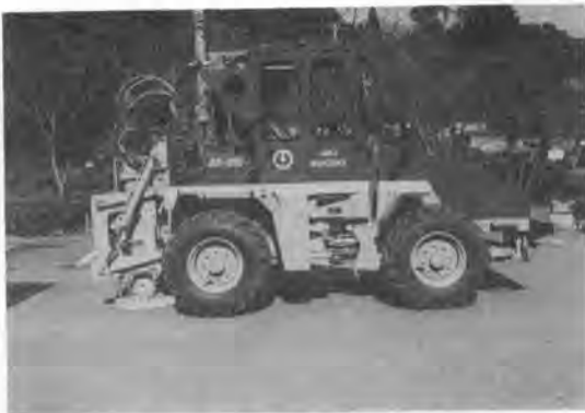
写真-2 作業中の油圧インパクト
