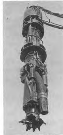
写真-1 ハイロックドリル装置
