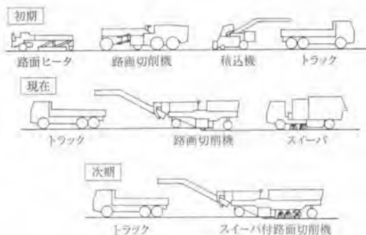
図-9 路面切削工事の機械編成
