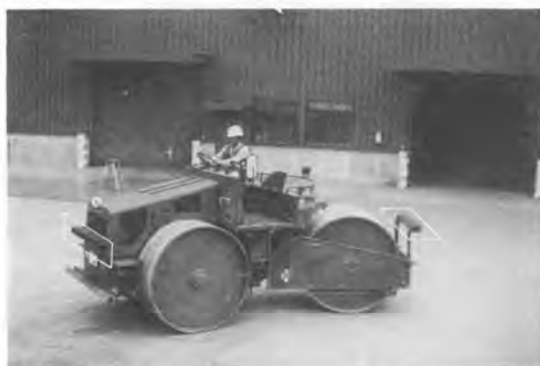
写真-3 ローラ車に実装試験中のシステム (アレイホーン)
