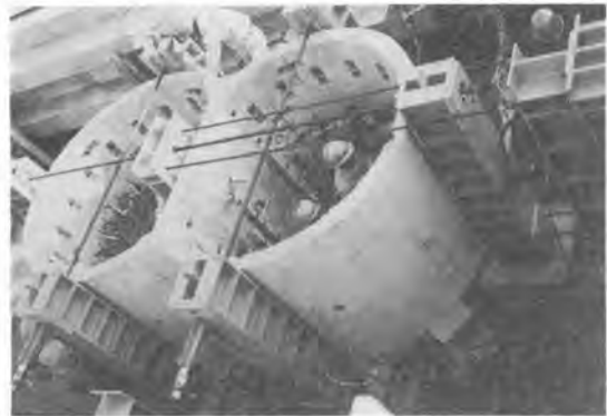
写真-2 セグメントリング载荷試験
