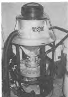
写真-5 スラリー回収圧送装置
